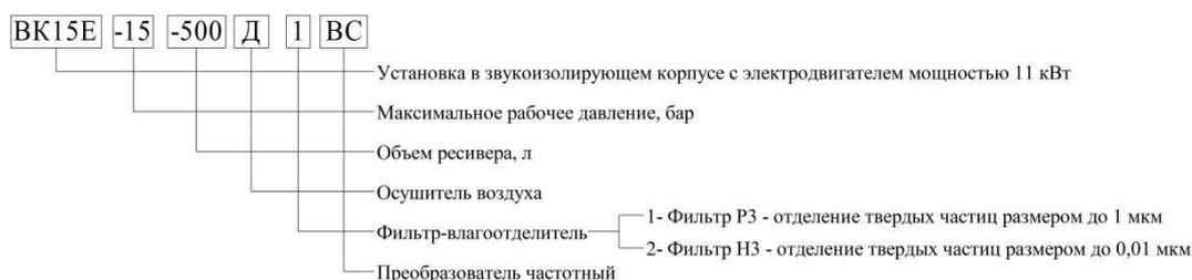
Примечание - В исполнении ВК15Е-...-500ДВС (с осушителем) установка укомплектована фильтром S3 со степенью фильтрации 3 мкм.
